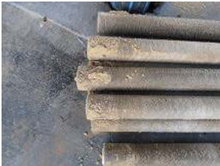
Problème de sable farineux dans l'eau des forages F2 + F3
